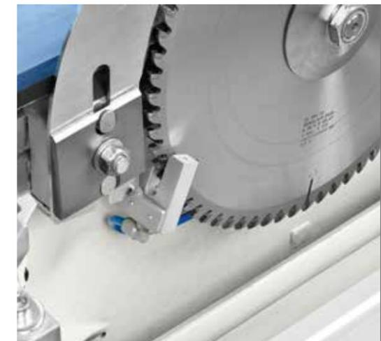
**Dispositif pour coupes angulaires prédéfinies positionné directement sur le châssis d'équarrissage**
