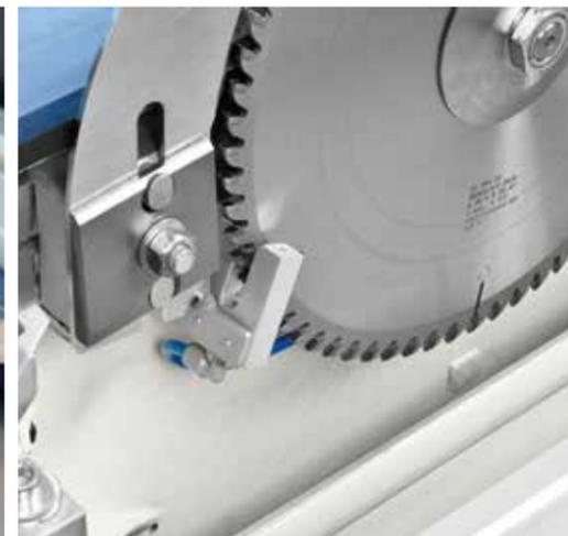
**Dispositif de micro-lubrification de la lame**
